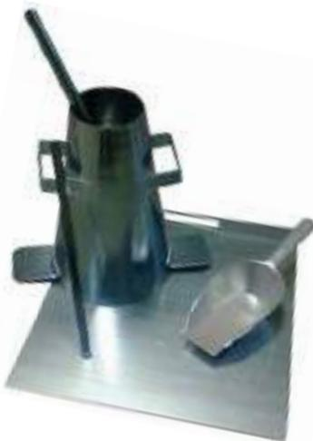
Per determinare la lavorabilità del calcestruzzo fresco. Viene proposto in versione standard, indicato sia per prove di laboratorio che per prove in sito.
