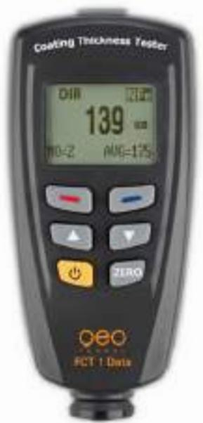
Spessimetro per rivestimento compatto con sonda incorporata a doppia tecnologia "FN" per la misurazione di rivestimenti (vernice, zinco, plastica, gomma, ceramica, ecc.) sia su materiali metallici ferrosi "F" (acciaio al carbonio, ferro, ghisa, ecc.) che su materiali metallici non ferrosi "N" (acciaio inox, alluminio, rame, ecc.).
