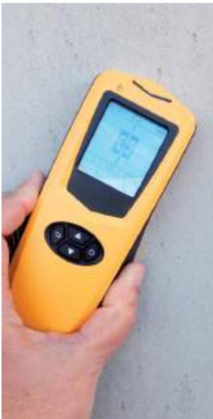
Il pacometro TECNIX PaCo è uno strumento che permette di rilevare in maniera non distruttiva la presenza, la direzione e il diametro delle barre di armatura all'interno di elementi in calcestruzzo armato inoltre consente a misura dello spessore del copriferro e l'interferro.
