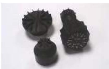
Scissometro manuale indicato per la determinazione della resistenza al taglio di terreni coesivi sia in situ che su campioni in laboratorio.
