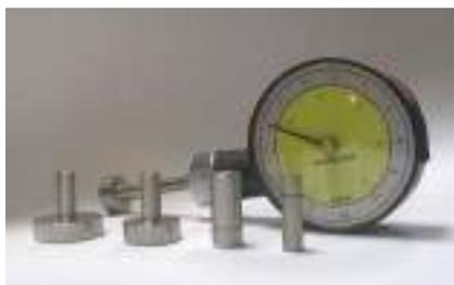
Strumento tascabile per la rapida determinazione delle resistenze alla penetrazione dei terreni di fondazione in condizioni non drenate.
