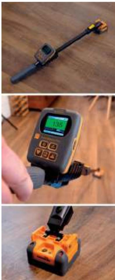
Il ReachMaster Pro è un misuratore di umidità non invasivo, in radiofrequenza, che consente la valutazione rapida delle condizioni di umidità negli edifici.
