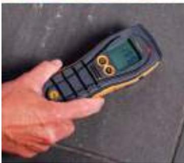
Il Protimeter Aquant è particolarmente indicato per la rilevazione dell'umidità nella vetroresina, nei materiali vinilici e plastici in generale; trova pertanto la sua naturale applicazione nel controllo dell'umidità su camper, caravan, veicoli speciali, imbarcazioni, locali medicali rivestiti da resine di protezione, locali pubblici quali piscine, etc...
