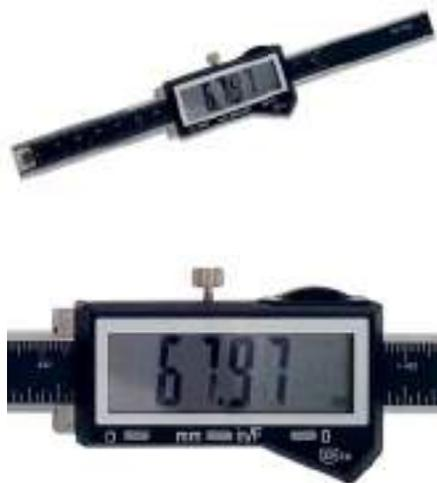
Questo strumento è adatto al controllo e alla misura di crepe e fessure che interessino strutture murarie e pavimenti. Alle estremità della crepa vengono fissate o cementate due piastrine forate in polimero trasparente.
