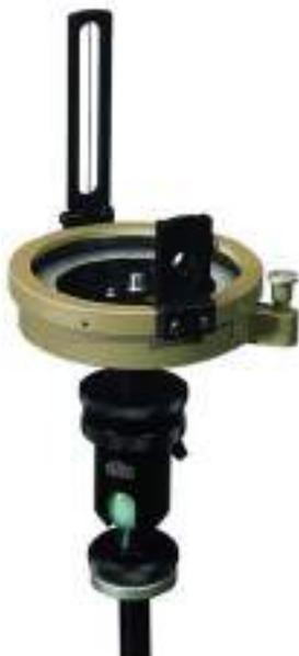
Tipo Schmalkalder, bussola prismatica con sistema di collimazione a traguardo incernierato e regolabile per rilievi topografici,
