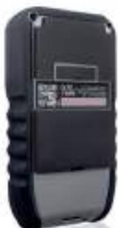
Il Tramex Moisture Encounter 5 (ME5) è un igrometro per misurazioni non distruttive NDT istantanee e precise dell'umidità di legno, pavimenti, cemento, cartongesso, massetti e materiali edili in genere.
