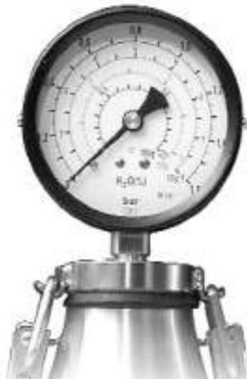
Per determinare con precisione ed in breve tempo il tasso di umidità nei materiali da costruzione, ideale per sabbie, terre e massetti (distruttivo).
