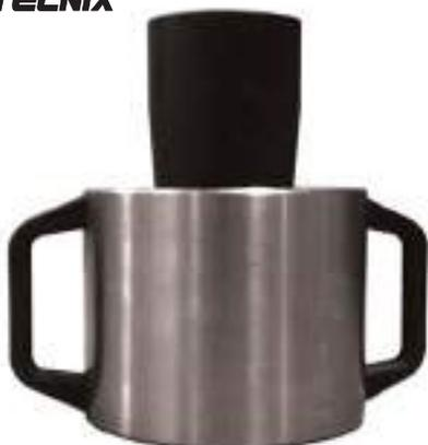
Accessorio per il controllo della taratura dello sclerometro meccanico ed elettronico. A garanzia di un buon risultato, in ottemperanza a quanto specificato dalla normativa (UNI 12504-2), si consiglia di effettuare controlli sistematici dello strumento utilizzando l'apposita incudine di taratura.
