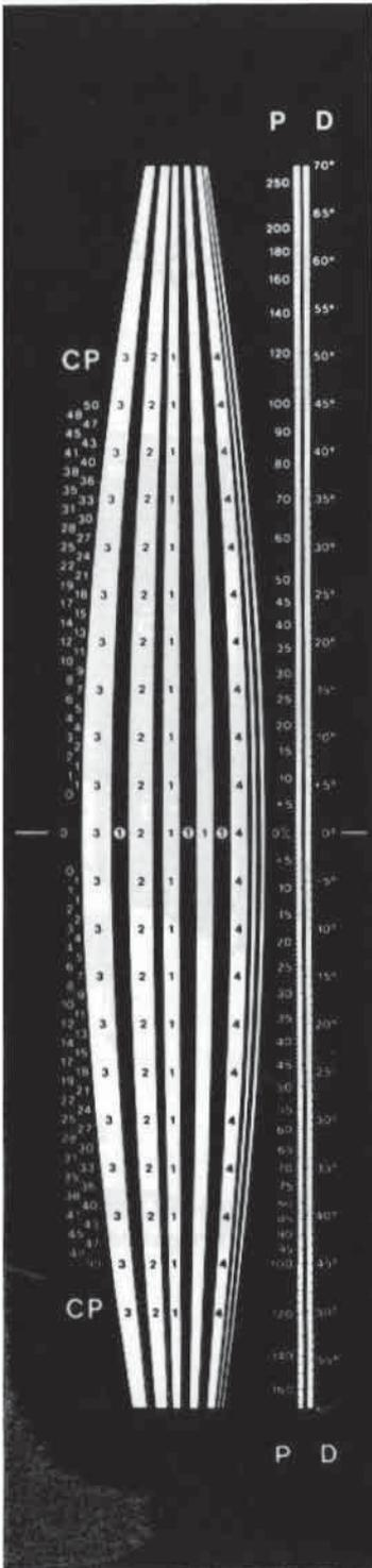
Figura 4 - Visione completa delle scale e delle bande del relascope "metrico C P".
