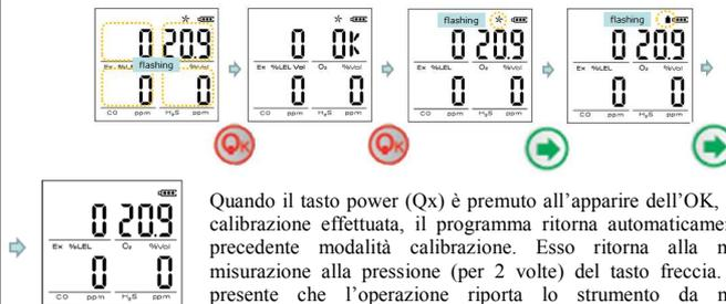
Quando il tasto power (Qx) è premuto all'apparire dell'OK, dopo la calibrazione effettuata, il programma ritorna automaticamente alla precedente modalità calibrazione. Esso ritorna alla modalità misurazione alla pressione (per 2 volte) del tasto freccia. Tenere presente che l'operazione riporta lo strumento da modalità misurazione a modalità standard.
